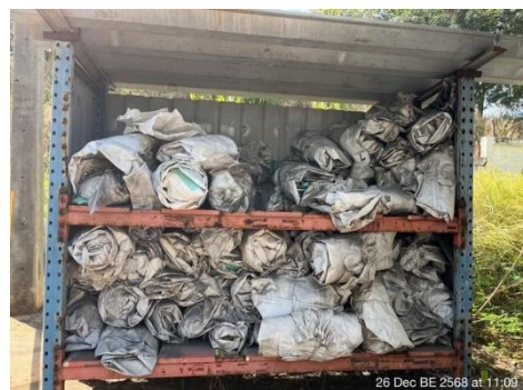
ภาพที่ 2-23 ถังจัมโบ้ (big bag) สำหรับรวบรวมฝุ่นจากระบบดักฝุ่นแบบถุงกรอง
